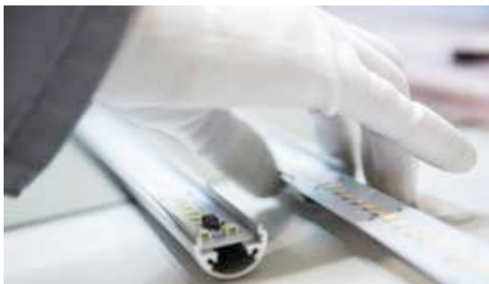
(Bildquelle: Deutsche Lichtmiete / Mario Dirks) Bildunterschrift: Montage der Platinen bei LED-Röhren T8 concept light der Deutsche Lichtmiete Unternehmensgruppe in Oldenburg
