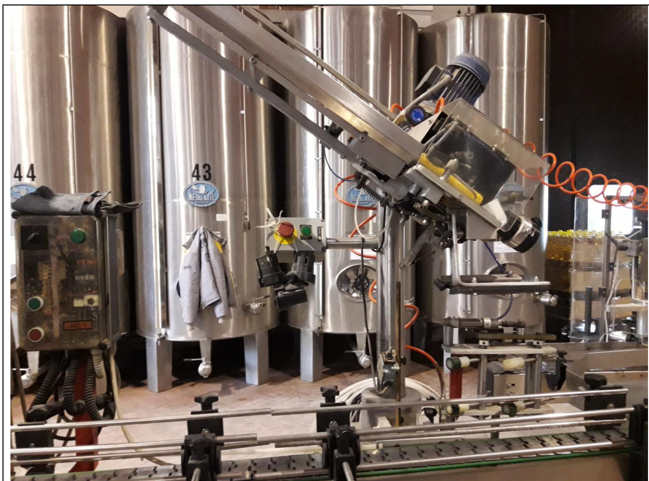
164 – Distributore capsule in PVC OMB: NON FUNZIONANTE (r)
