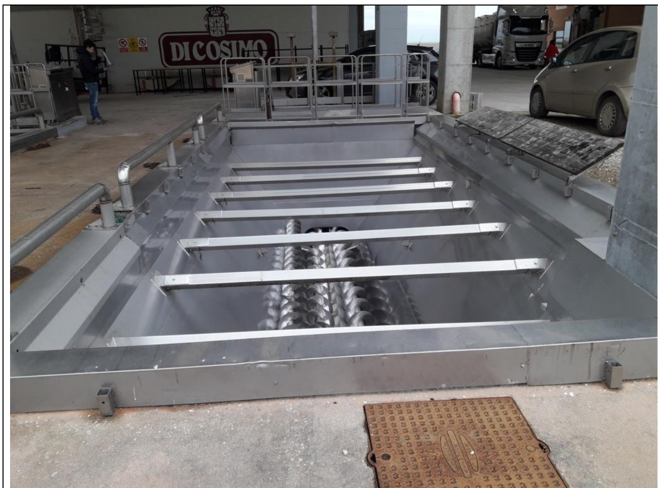
138, 139 – Vasca raccolta uve in acciaio (m 3.80 x m 8.00) con annesso quadro elettrico (a)
