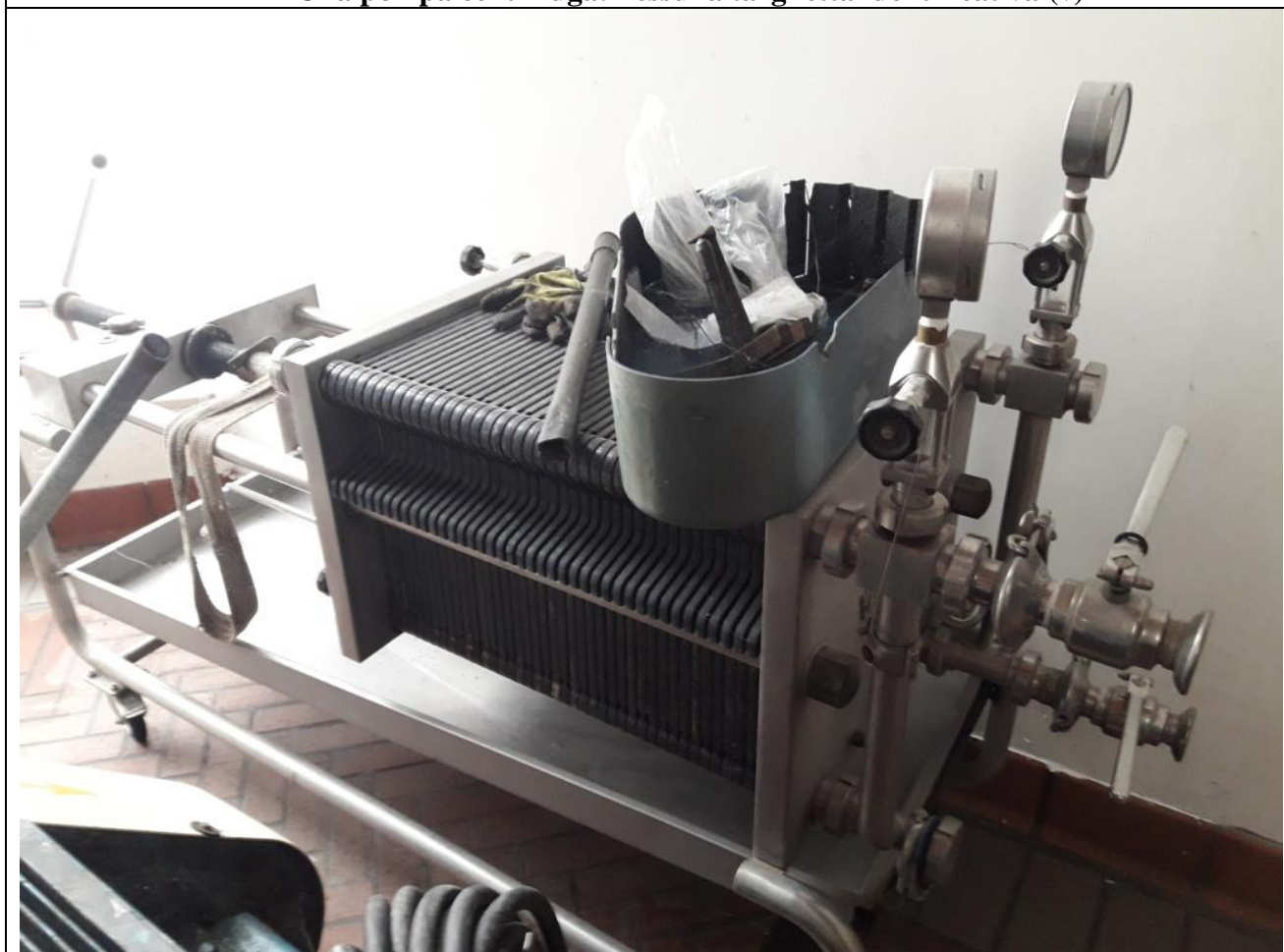
172 – Un filtro a cartoni 40 x 40 AMF PADOVAN: NON FUNZIONANTE (x)
