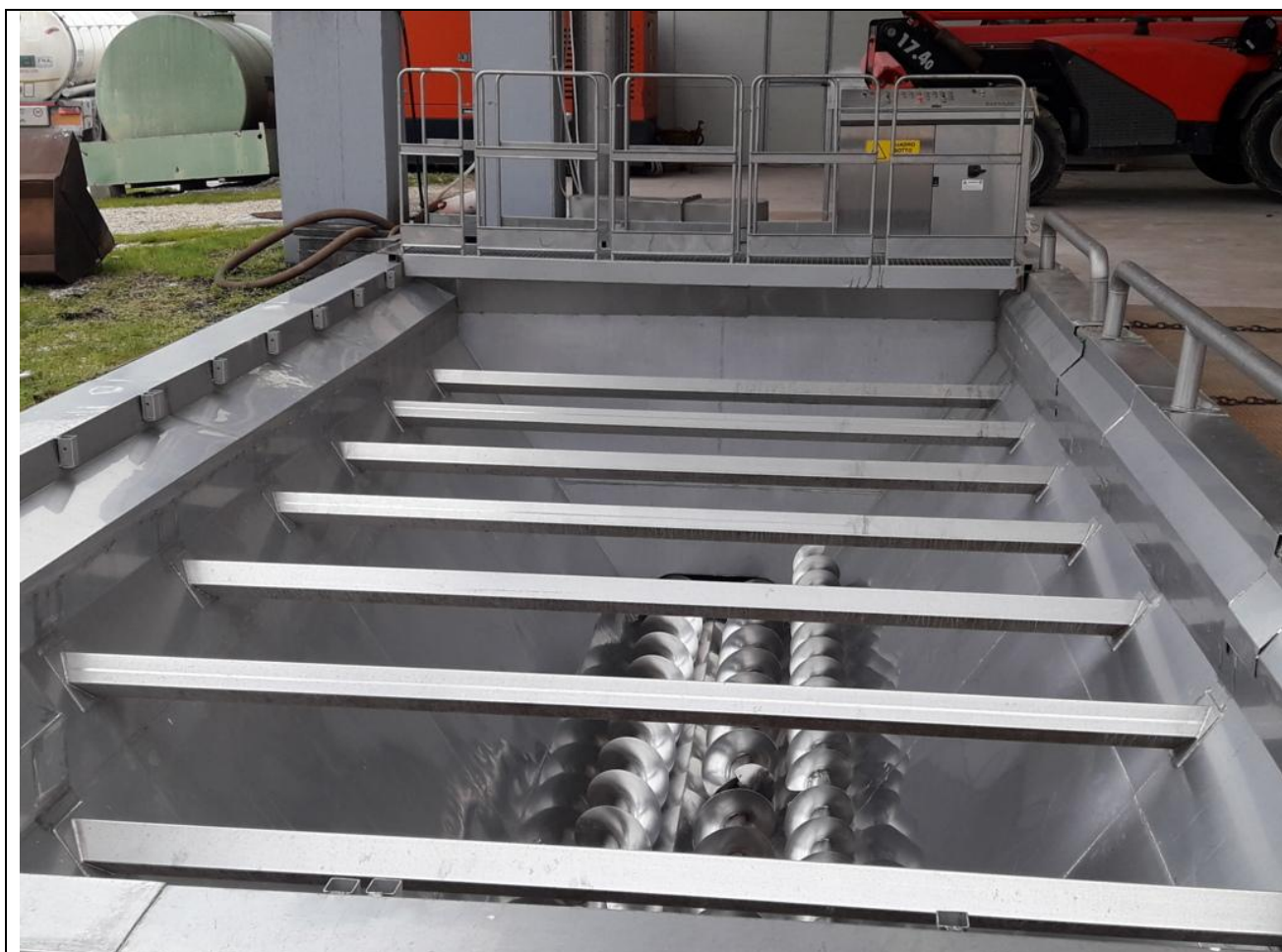
140, 141 – Vasca raccolta uve in acciaio (m 3.80 x m 8.00) con annesso quadro elettrico (d)
