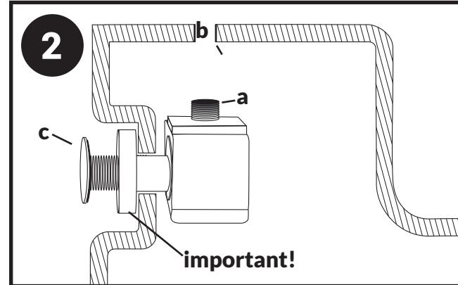
**BRINGEN SIE ZUNÄCHST DAS BEFESTIGUNGSSET AM WC AN:** In der Rückseite des WCs befinden sich zwei Löcher für die Montage. Dort werden die beiden Montagehalter von der Innenseite eingesetzt. Die Befestigungsschraube mit dem Innensechskant (a) weist dabei nach oben, also in Richtung Anschlussloch (b) des WC-Deckels. Anschließend fixieren Sie den Montagehalter, indem Sie die Mutter (c) ohne zusätzliches Werkzeug mit der Hand festziehen.
