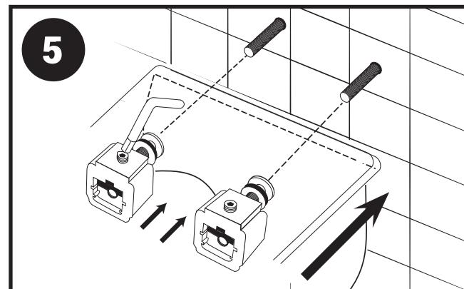
**SETZEN SIE NUN DIE IM WC ANGEBRACHTEN MONTAGEHALTER VORSICHTIG AUF DIE GEWINDESTANGEN.** Wie unter 2 beschrieben, sollten die beiden Imbusköpfe dabei nach oben weisen. Der Sechskantschlüssel wird in einen der beiden Montagehalter eingesetzt. **Schieben Sie jetzt das WC bis an die Wand.** Bewegen Sie das WC wenn nötig dabei leicht auf- und abwärts, um das Aufschieben zu erleichtern.
