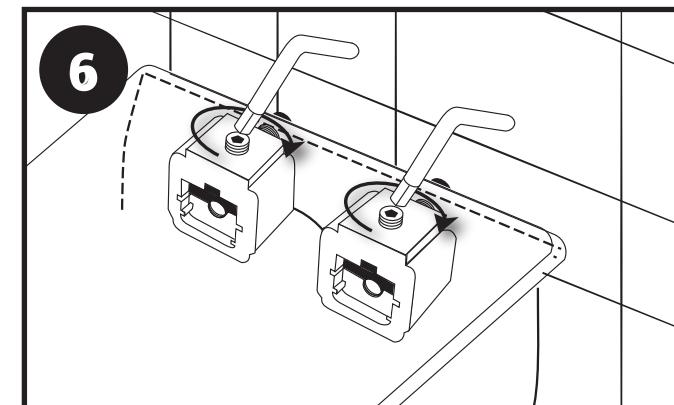
**ZIEHEN SIE ES JETZT MIT DEM SECHSKANTSCHLÜSSEL FEST.** Drehen Sie den bereits eingesetzten Sechskantschlüssel so lange, bis das WC beginnt, sich in Richtung Wand zu bewegen. Wechseln Sie jetzt mit dem Sechskantschlüssel auf den zweiten Montagehalter und ziehen Sie hier die Schraube an, so dass das WC fest an die Wand gezogen wird. Wechseln Sie wieder die Seite und ziehen Sie auch hier die Schraube so fest, dass das WC fest an der Wand fixiert ist.
