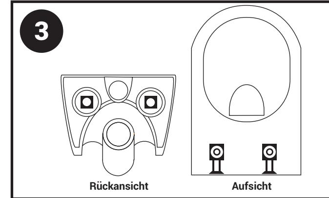
**DIESES BILD ZEIGT DIE BEIDEN AM WC ANGEBRACHTEN MONTAGEHALTER:** links die Ansicht der Rück-/Wandseite des WCs, rechts der Blick von oben. Die Montagehalter sollten so angebracht werden, dass sie sich nicht leicht verdrehen lassen, aber noch die Möglichkeit besitzen, sich an dem Abstand der Gewindestangen des Vorwandelementes auszurichten.
