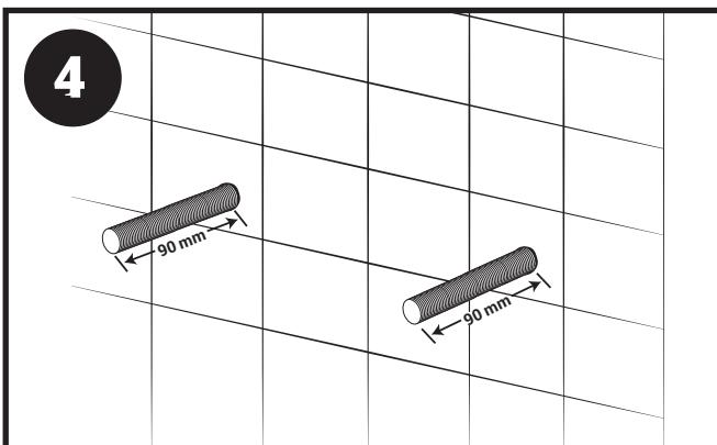
**DIE BEIDEN GEWINDESTANGEN DES VORWANDELEMENTS** sollten so angebracht werden, dass sie ca. 90 mm aus der Wand ragen.
