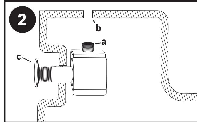
**BRINGEN SIE ZUNÄCHST DAS BEFESTIGUNGSSET AM WC AN:** In der Rückseite des WCs befinden sich zwei Löcher für die Montage. Dort werden die beiden Montagehalter von der Innenseite eingesetzt. Die Befestigungsschraube mit dem Innensechskant (a) weist dabei nach oben, also in Richtung Anschlussloch (b) des WC-Deckels. Anschließend fixieren Sie den Montagehalter, indem Sie die Mutter (c) ohne zusätzliches Werkzeug mit der Hand festziehen.
