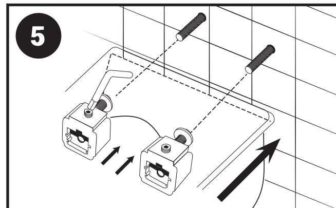
**SETZEN SIE NUN DIE IM WC ANGEBRACHTEN MONTAGEHALTER VORSICHTIG AUF DIE GEWINDESTANGEN.** Wie unter 2 beschrieben, sollten die beiden Imbusköpfe dabei nach oben weisen. Der Sechskantschlüssel wird in einen der beiden Montagehalter eingesetzt. **Schieben Sie jetzt das WC bis an die Wand.** Bewegen Sie das WC wenn nötig dabei leicht auf- und abwärts, um das Aufschieben zu erleichtern.
