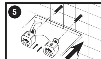
**6. A QUESTO PUNTO, FISSATELO CON LA CHIAVE ESAGONALE.** Girate la chiave già inserita fino a quando il WC non inizia a muoversi verso il muro. Ora passate con la chiave esagonale alla seconda staffa di montaggio e stringete la vite in modo che il WC sia attaccato saldamente al muro.
