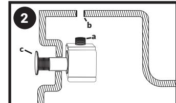
**3. QUESTA IMMAGINE MOSTRA LE DUE STAFFE MONTATE AL WC:** A sinistra un'immagine della parte posteriore (a muro); a destra un'immagine dall'alto. Le staffe dovrebbero essere installate in modo tale da non poter più girare facilmente, ma abbiano ancora la possibilità di allinearsi alla distanza delle barre filettate dell'elemento a parete.
