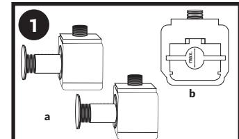
2. Per prima cosa **MONTATE LE VITI AL VOSTRO WC:** Nella parte posteriore del WC troverete due fori di montaggio. Inserite le due staffe nella parte interna lasciando la vite con testa incava esagonale (a) rivolta verso l'alto, nel verso del collegamento (b) del coperchio. Infine fissate le staffe, avvitando la madrevite con le mani senza ricorrere ad alcun attrezzo (c).
