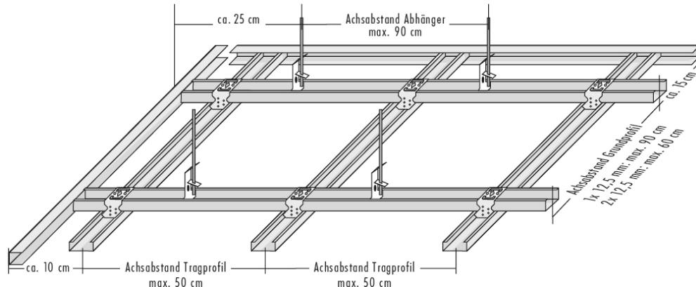
Anschließend kann die Unterkonstruktion gedämmt und beplankt werden. Decken müssen grundsätzlich quer und mit Knauf Gipsplatten einer Mindeststärke von 12,5 mm beplankt werden. Zur Beplankung von CD- und UD-Profilen mit Knauf Gipsplatten werden je nach Plattenstärke Knauf Schnellbauschrauben Feingewinde in verschiedenen Längen verwendet (TN 3,5 x 25 mm bei einfacher Beplankung; TN 3,5 x 35 mm bei doppelter Beplankung / Schraubenabstand Deckenbereich max. 17 cm).
