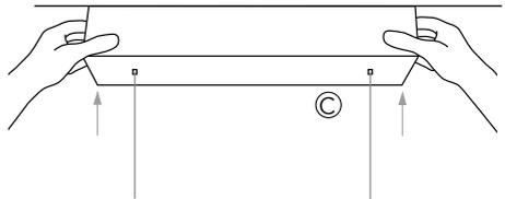
Ist die Feststellung eingestellt, schieben Sie den Baldachin (C) wieder auf den Deckenbügel bis die Magnete den Baldachin fixieren.
