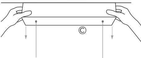
**Stellen Sie vor dem Feststellen sicher, dass die Leuchte stromlos ist!** Ziehen Sie mit einem kräftigen Ruck den Baldachin (C) hinunter. Dieser ist über Magnete befestigt und einfach abzuziehen.
