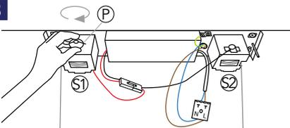
Vor Kopf der Rollzüge (S1, S2), jeweils auf der gegenüberliegenden Seite, befindet sich eine große Schraube (P), die gut mit den Finger zu fassen ist. Diese ein wenig im Uhrzeigersinn drehen und somit das Tragseil wieder feststellen. Dabei ist zu beachten, dass ein zu starkes Festdrehen der Feststellbremse die Rollzüge blockiert und die Leuchte dann nicht mehr in der Höhe zu verstellen ist. Dann wieder gegen den Uhrzeigersinn aufdrehen.
