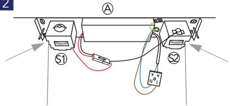
Rechts und links am Deckenbügel (A) finden Sie jeweils einen kleinen Kasten (S1, S2), in dem sich die Tragseile befinden. Das sind die Rollzüge (S1, S2).
