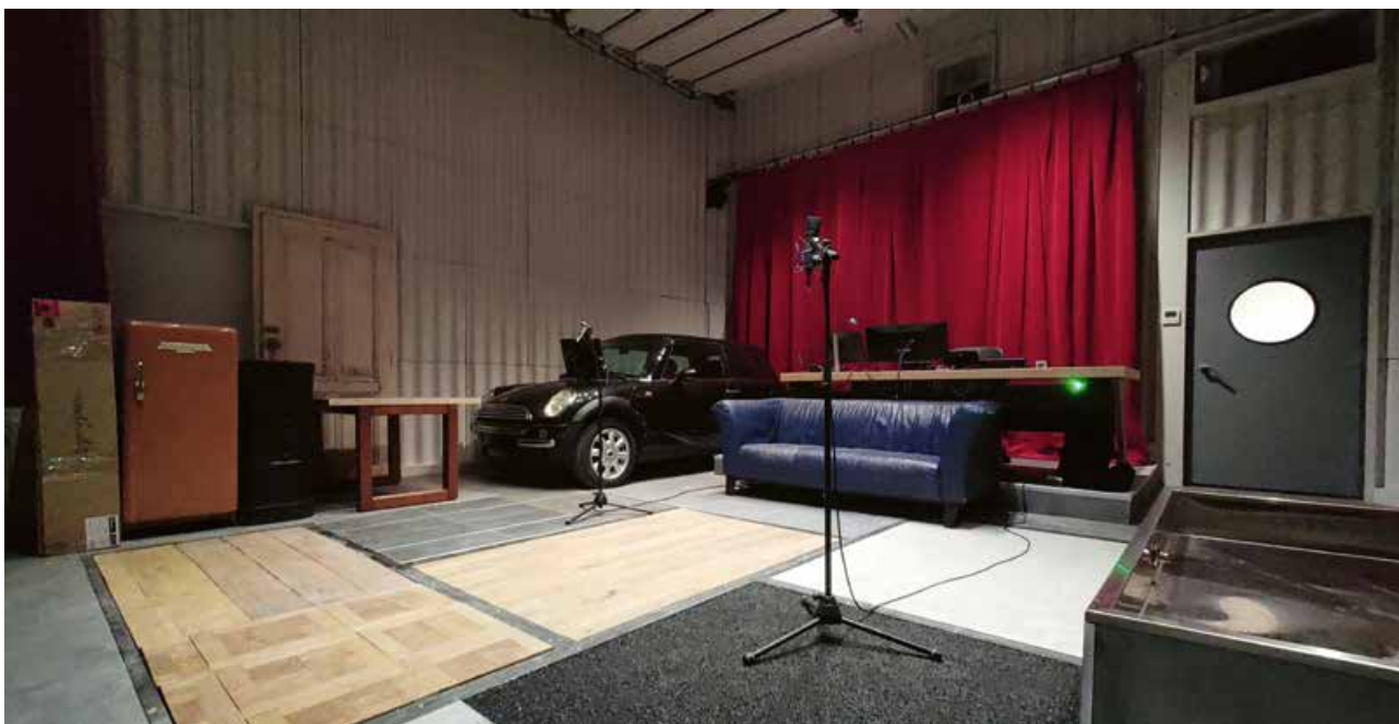
L'auditorium de bruitage de Masé Studios, à Satigny, est conçu pour faire varier l'acoustique selon les scènes, grâce notamment aux rideaux et aux éléments mobiles du plafond. © Masé Studios
