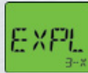
Explosimeter 3 scales : PPM, % LEL, % Vol. gas
